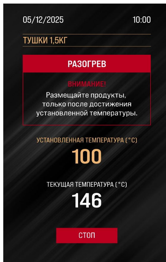
Рисунок 15 – Остановка работы в автоматическом режиме
